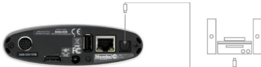
Ligar um cabo óptico S/PDIF da saída óptica S/PDIF do decodificador Amino A139 à entrada óptica S/PDIF do amplificador ou “Home Cinema”.
