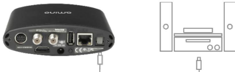
Ligar um cabo óptico S/PDIF da saída óptica S/PDIF do decodificador Amino A140 à entrada óptica S/PDIF do amplificador ou “Home Cinema”.
